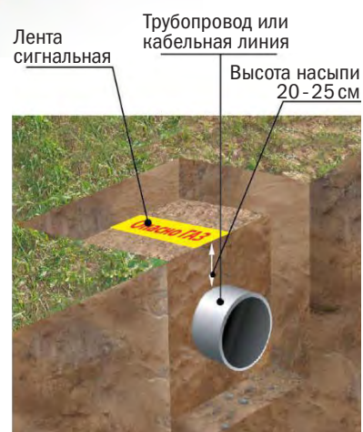
Типовая схема укладки сигнальных лент
