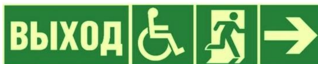
Рисунок 5 — Пример комбинации эвакуационных знаков
